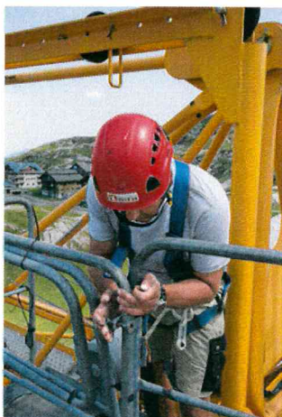
Bilder unten: Zwei Leiterelemente sind nicht bündig montiert, was Rieder umgehend in seiner Kontrollliste festhält. Einen Handlauf schraubt er noch ordnungsgemäss fest.
